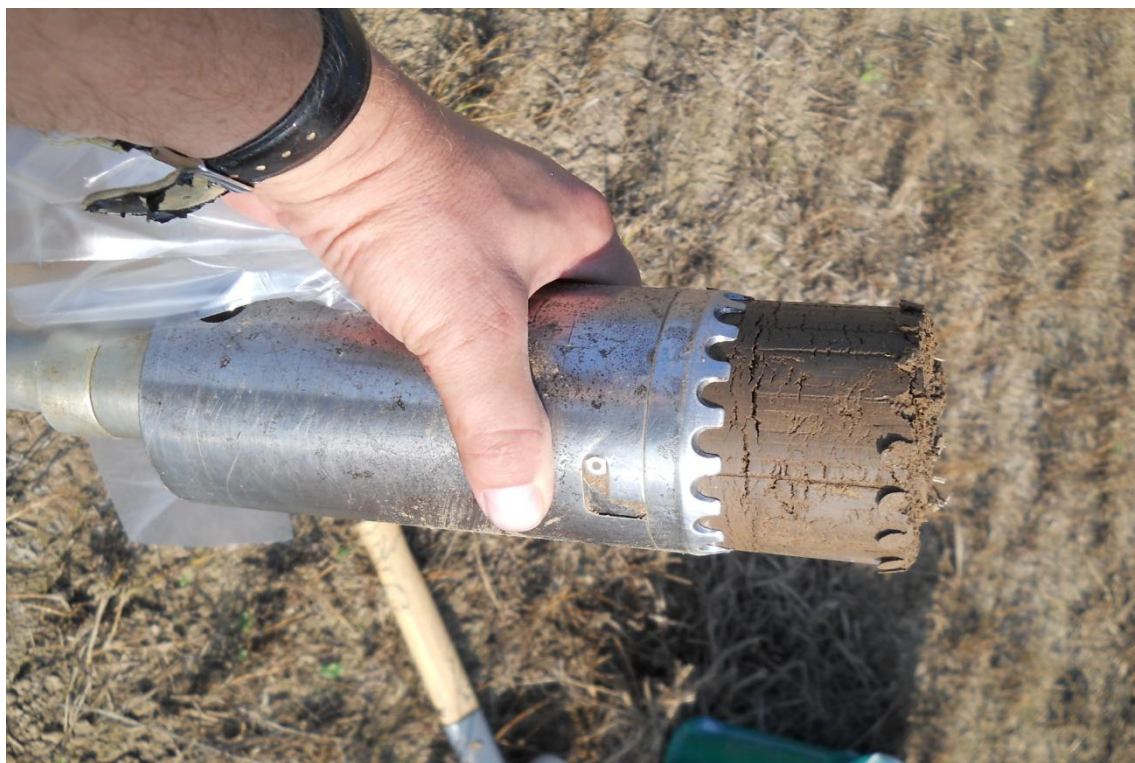
Příloha 2: Vytlačení vzorku z kořenového vrtáku
