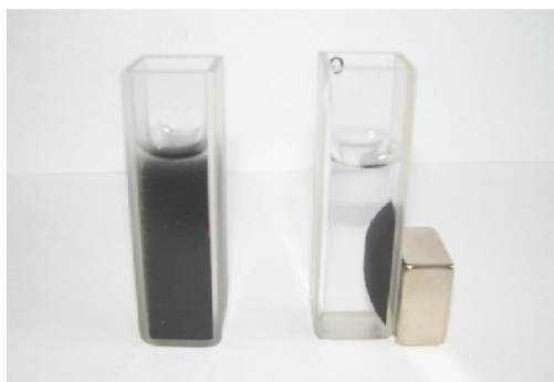
Obr. 7 Separace magnetických celulosových mikročástic vnějším magnetickým polem (magnetem). Rozsuspendované MCM v pufru ( 0,05 \text{ mol.l}^{-1} K-P i , pH = 7,5) před magnetickou separací (vlevo) a po magnetické separaci (vpravo).
