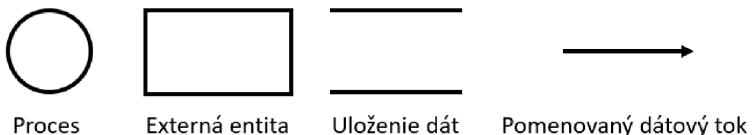
Obrázok č. 13: Prvky diagramu toku dát podľa štýlu Yourdon and Coad (Zdroj: Vlastné spracovanie podľa [15])
