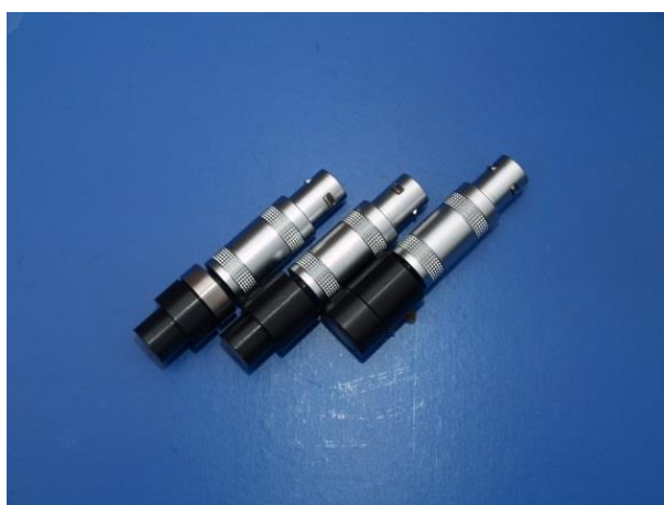
Obr. 6.2 Sondy vířivých proudů pro kontrolu kompozitních uhlíkových materiálů
