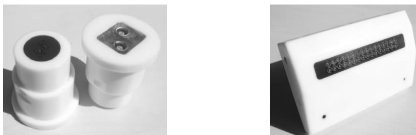
Obr. 3.24 Ukázka anizotropního senzoru (vlevo), 16 párového senzoru (vpravo) [12]
