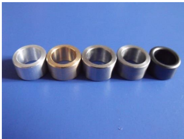
Obr. 6.1 Stínící kroužky v pořadí hliník, mosaz, austenitická ocel, slitina železa, ferit
