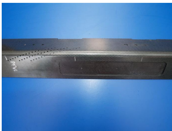
Obr. 6.8 Kalibrační měrka s popisem jednotlivých umělých vad – ABS 5045 laminát (vzorek 5)
