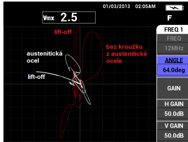
Obr. 7.34 EC signály jednotlivých stínících kroužků u sondy COMPROBE 10 MHz (přístroj Nortec 600D)
