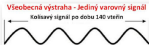
Obr.: Akustický tvar varovného signálu
