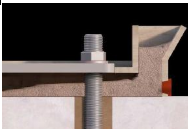
Obrázek č. 4 Nalévání zálivky do bednění [11]
